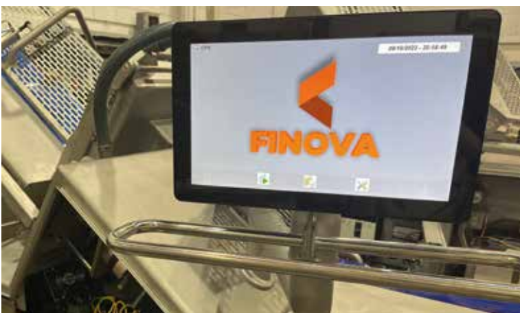
Fra i dispositivi utilizzati nella macchina figurano 2 unità HMI della serie HMs con grado di protezione IP67
