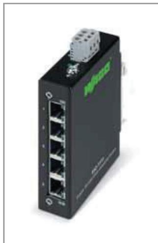
tramite elenco di indirizzi MAC. La comunicazione full-duplex è conforme IEEE 802.3x e il range di temperatura operativa è compreso tra 0 e 60 °C. I LED del pannello anteriore consentono una rapida diagnostica visiva sul posto, mentre l'alimentazione varia tra 18 e 30 Vc.c. e la protezione da sovratensione è integrata per fornire un'ulteriore sicurezza.
