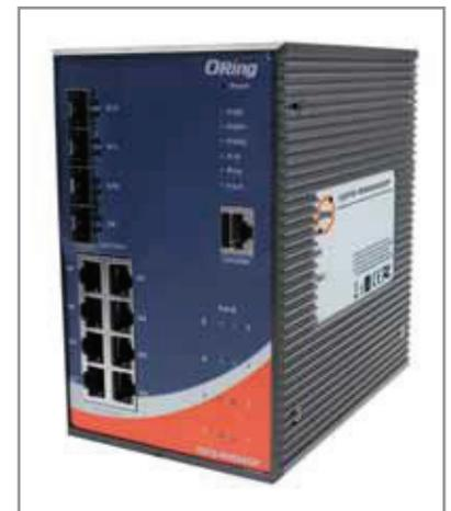
tratta di switch Ethernet industriali che permettono una trasmissione dei dati cross-network, ma dividono anche le reti in diversi segmenti per raggiungere un più elevato livello di sicurezza. In particolare, Digimax propone il nuovo switch PoE industriale a 12 porte con 8x10/100/1000Base-T(X) PSE e 4x100/1000Base-X e presa SFP: Igps-R9084GP.
