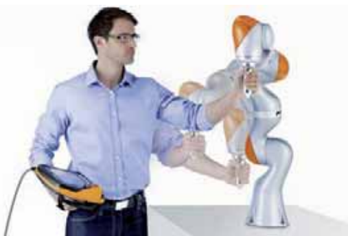
Il robot di Kuka è capace di interagire con gli operatori umani in completa sicurezza
