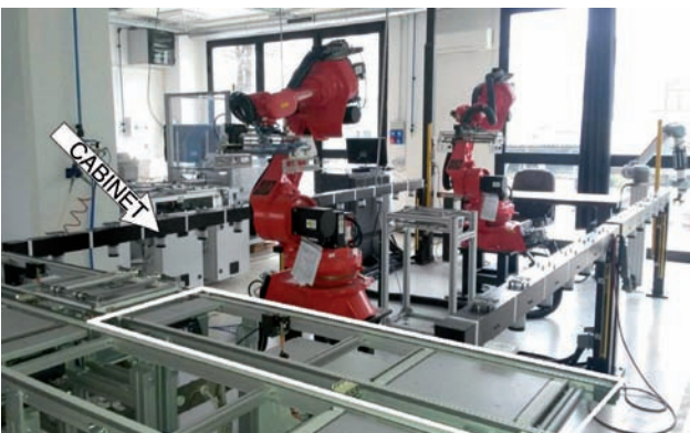
Figura 1 - Impianto per la riparazione, lo smontaggio e il riciclaggio di circuiti stampati
