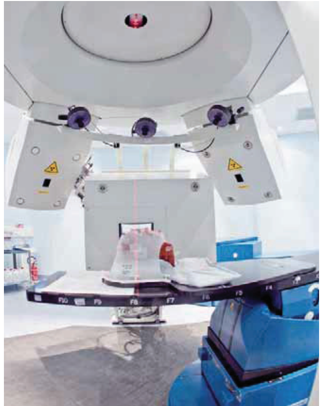
In una delle sale di trattamento, quella centrale, il fascio di adroni viene erogato anche verticalmente
