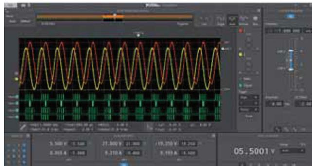
LVTTL compatibile 5 V, in input, e LVTTL da 3,3 V in output.
