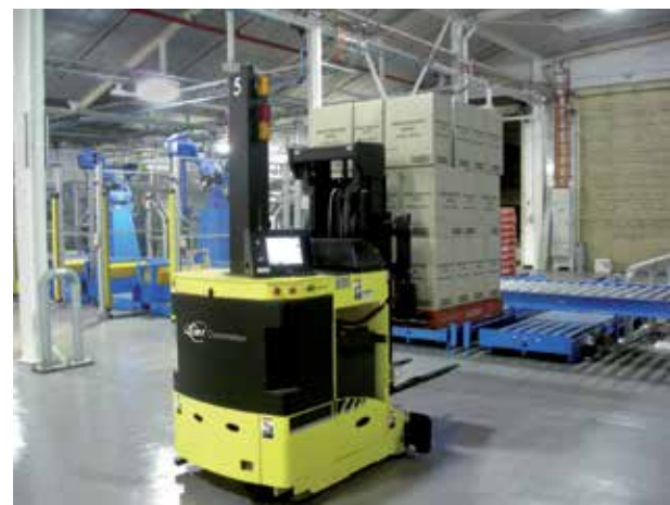
Esempio di AGV, uno dei più diffusi di sistema di material handling motorizzato non vincolato
