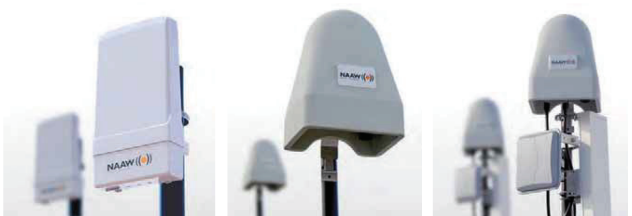
Figura 3 - Le antenne di Wi-Next per la realizzazione di reti mesh sono in grado di integrarsi con un ecosistema di sensori (Rfid, Zigbee ecc.) per un networking orientato al risparmio energetico
