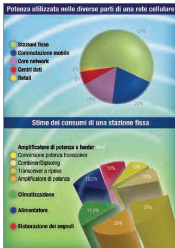
Figura 2 - in alto) Suddivisione della potenza assorbita dalle diverse componenti di una rete cellulare in basso) Stime dei consumi tipici di una stazione fissa
