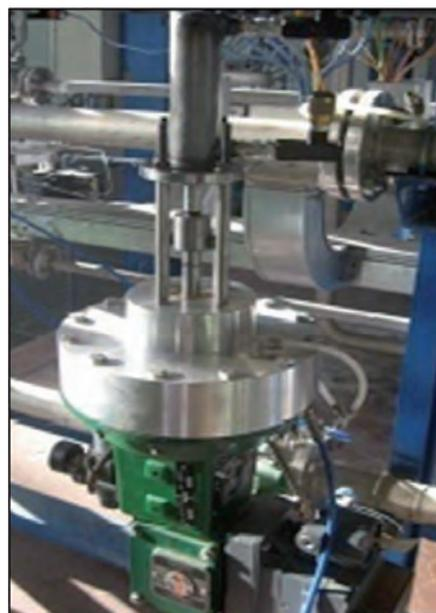
Figura 2 - Le valvole di regolazione modificate
