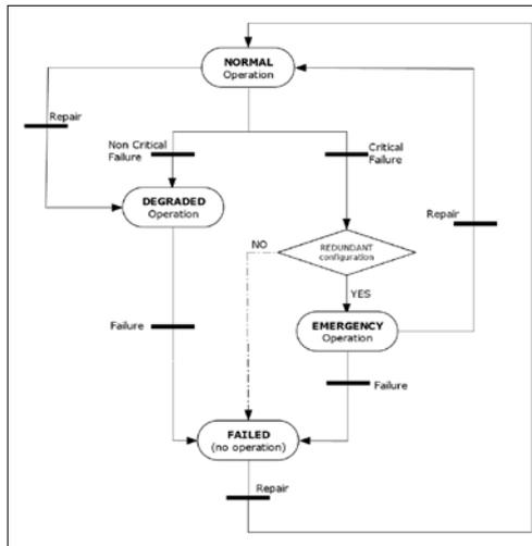
**Figura 4 - Schema a blocchi degli stati di funzionamento di un PCS**
