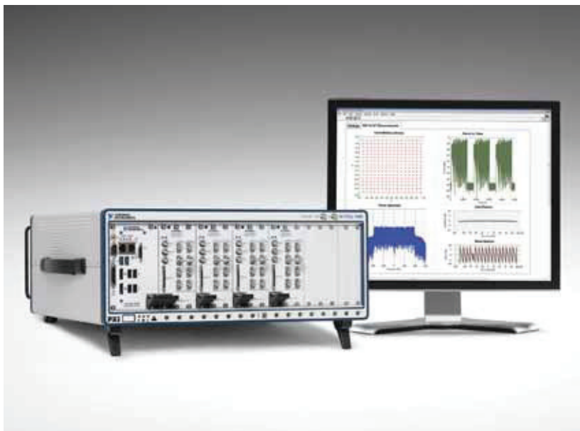
Un potente sistema di collaudo automatico di apparecchiature a radiofrequenza realizzato con i moduli PXI di National Instruments, le cui funzioni sono definite dal software di controllo basato sul sistema di programmazione grafica LabView
