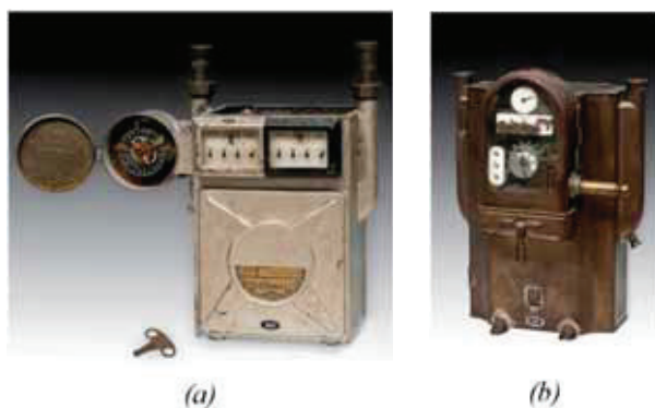
Figura 5 - (a) Contatore in grado di misurare in maniera diversificata al fine di poter applicare la tariffa bioraria. Nella sinistra era presente un orologio che veniva programmato sulle fasce previste al fine di poter suddividere nei due numeratori predisposti, numeratore bianco per il giorno e numeratore nero per la notte. Questo consentiva di incentivare i consumi nei momenti di minor consumo con tariffe agevolate. (b) In questo contatore si vede la fessura entro la quale si dovevano inserire le monete, dopo aver spinto il pistone a destra si ricaricava il sistema in maniera proporzionale all'importo inserito ed il contatore erogava quanto previsto dopodiché si bloccava. Le monete cadevano in un contenitore (mancante) chiuso che un incaricato provvedeva a ritirare periodicamente.
