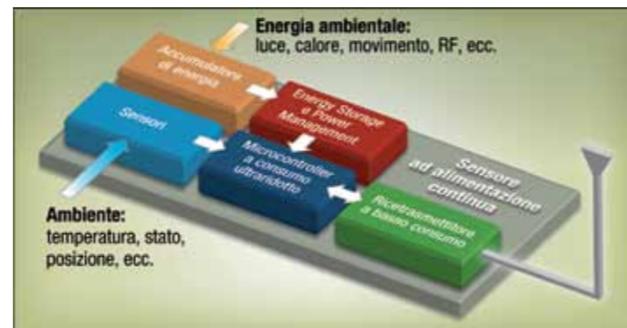
Esempio di schema a blocchi delle funzionalità del nodo sensore
