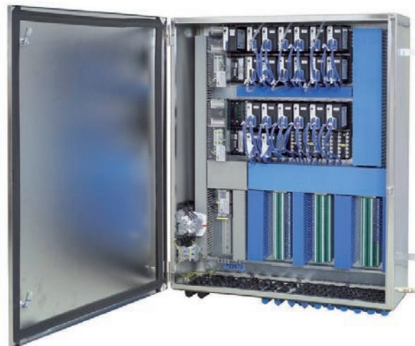
*Cabinet in AISI 316 L contenente un sistema di I/O remoto serie FB per installazione in zona 1/21, completo di backplane base ed estendibile, schede per segnali a sicurezza intrinseca analogici e digitali di ingresso e uscita*
