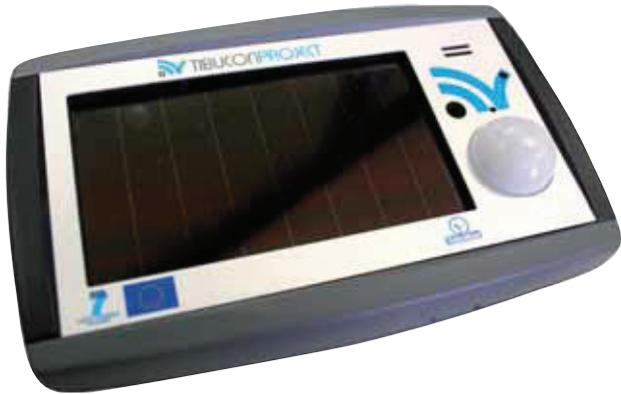
**Il fotovoltaico è stato in grado di adattarsi ai diversi contesti del progetto Tibucon lasciando ai dispositivi termoelettrici il compito di back up**
