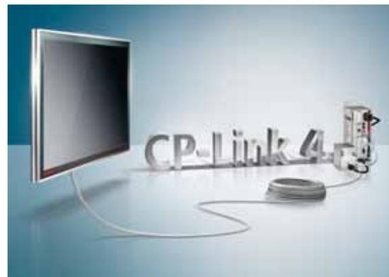
CP-Link 4 è per pannelli operatori situati fino a 100 m di distanza dal PC industriale. La soluzione a singolo cavo può essere utilizzata per trasferire i segnali video, USB 2.0 e l'alimentazione elettrica in un cavo standard CAT 7, riducendo così i costi di installazione e cablaggio. Un ulteriore vantaggio è l'utilizzo di display puramente passivi. CP-Link 4 è supportata dai nuovi pannelli multi-touch serie CP29xx-0010 e CP39xx-0010.
