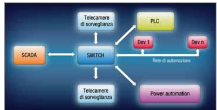
Fig. 8 - Architettura di rete ibrida
