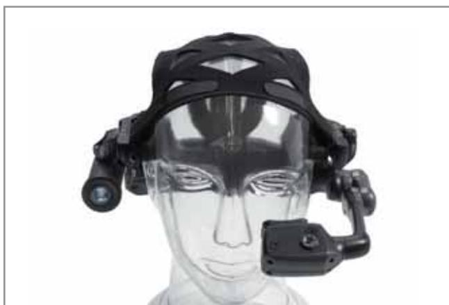
**Il wearable computing offre il mezzo per fruire delle informazioni di manutenzione senza occupare le mani dell'operatore (fonte: Motorola)**
