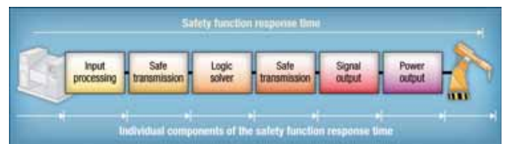
Figura 7 - Tempo di risposta della funzione di sicurezza
