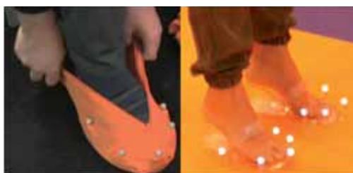
Figura 2 - Con i calzari si rileva in tempo reale la posizione dei piedi e si mixa correttamente l'immagine della scarpa virtuale
