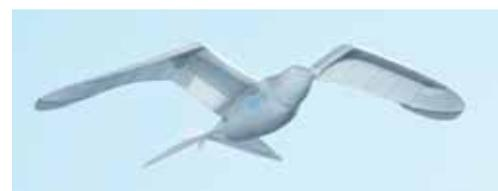
**SmartBird** (► in foto) è invece un vero e proprio "gabbiano robot" realizzato da Festo, in grado di volare e atterrare autonomamente, imitando fedelmente il battito d'ali e tutti i movimenti caratteristici di un volatile. I settori di applicazione ipotizzabili comprendono i generatori di potenza ad ala battente per il recupero di energia, fino ai servomotori nell'automazione di processo.
