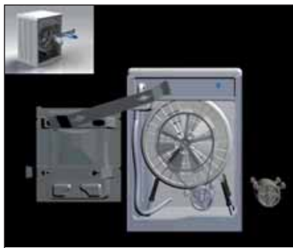
Figura 3 - Schermata dell'applicazione di manutenzione. Nella parte centrale è visibile il prototipo virtuale della lavatrice e l'avatar della mano dell'utente. Nella parte superiore a sinistra è rappresentato il manuale interattivo di manutenzione, ovvero l'indicazione dell'operazione da compiere che si aggiorna via via che l'utente compie le operazioni.
