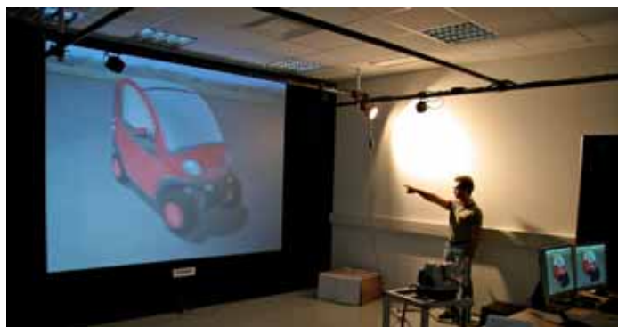
Figura - 1 Esempio di attività di design review dello stile di un'autovettura con prototipo virtuale di qualità fotorealistica.
