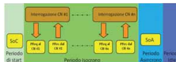
Figura 4 - Ciclo di funzionamento di Ethernet Powerlink
