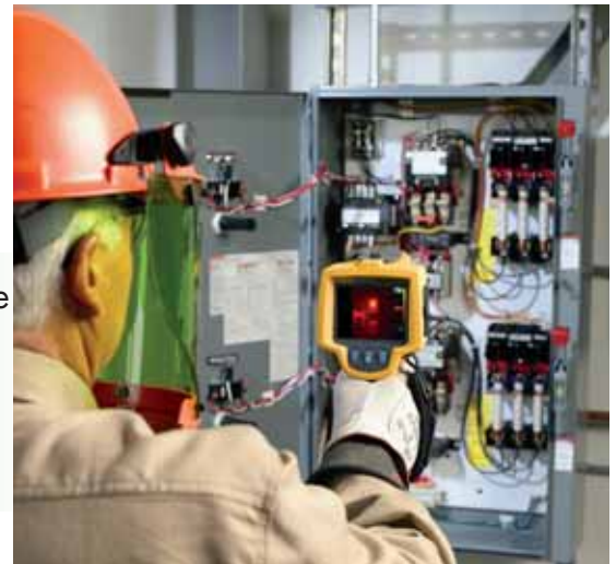
Identificazione guasti in un quadro elettrico con termocamera
