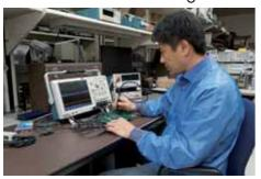
Gli MDO4000 Tektronix permettono di catturare contemporaneamente i segnali analogici, digitali ed RF correlati nel tempo
