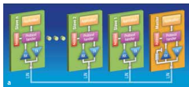
Due esempi di bus veicolari: LIN (a) veicola i segnali utilizzando un solo filo (oltre al ritorno di massa sullo chassis); CAN (b) utilizza segnali differenziali per offrire una superiore immunità ai disturbi
