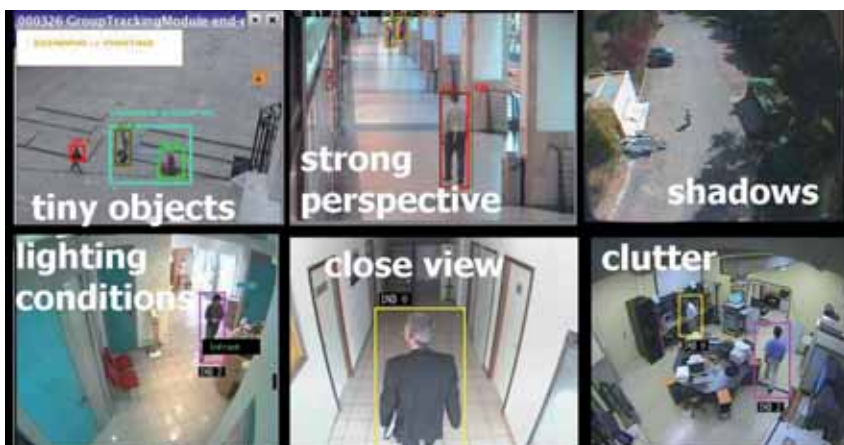
Fig. 4 - Esempi di object detection e tracking
