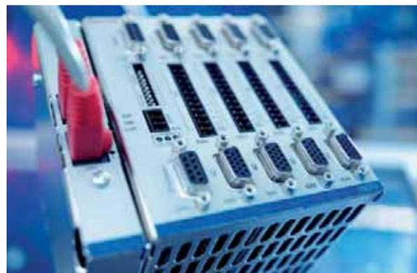
Controllore Multi-Asse HNC100-3X con interfaccia Ethernet (Rexroth)
