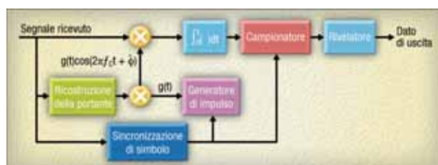
Figura 2 - Schema di principio di un ricevitore per segnali PSK
