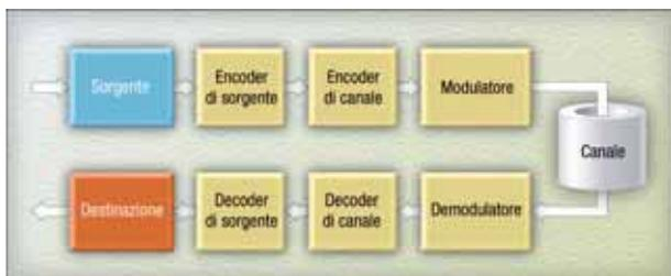
**Figura 1: Schema di un sistema di comunicazione digitale (o discreto)**
