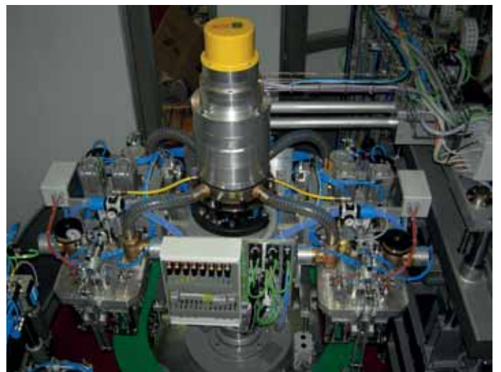
Pesatura e vuoto: particolare del nodo bus slave e i moduli di gestione dei segnali analogici e digitali
