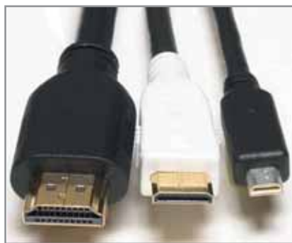
La specifica 1.4 aggiunge la versione micro alle serie standard e mini dei connettori Hdmi
