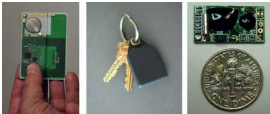
Esempi di tag Rubee impiegati per il monitoraggio di beni e materiali
