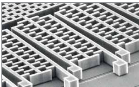
Particolare visto al microscopio della struttura micromeccanica in silicio che compone uno degli accelerometri Mems di ST Microelectronics
