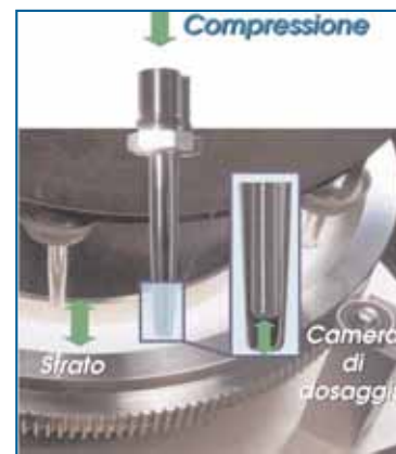
Figura 8 - Regolazioni per dosaggio polvere
