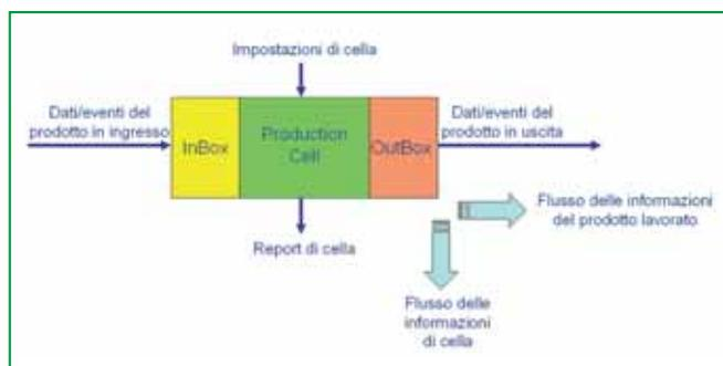
Nel primo caso la funzione locale, realizzata a livello di scheda di controllo, opera l'inseguimento della produzione attraverso una serie di informazioni temporali (eventi) di avanzamento del materiale in lavorazione (messaggi di tracking).
