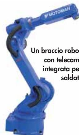
Un braccio robotico con telecamera integrata per la saldatura
