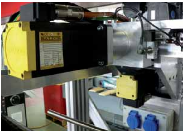
Due servomotori eseguono il controllo sul processo di avvolgimento della fibra in carbonio
