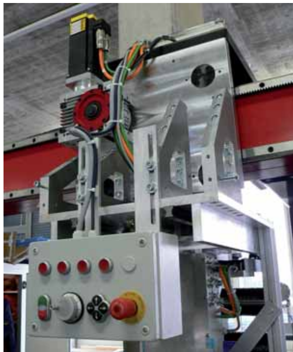
Un servomotore controlla il movimento dell'attrezzatura lungo la macchina per verificare la parte in fibra di carbonio
