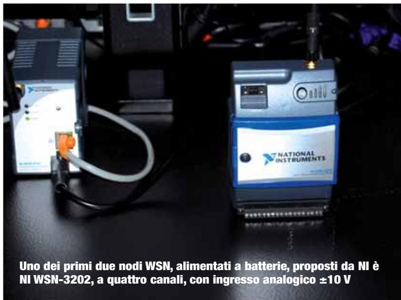
Uno dei primi due nodi WSN, alimentati a batterie, proposti da NI è NI WSN-3202, a quattro canali, con ingresso analogico  $\pm 10$  V
