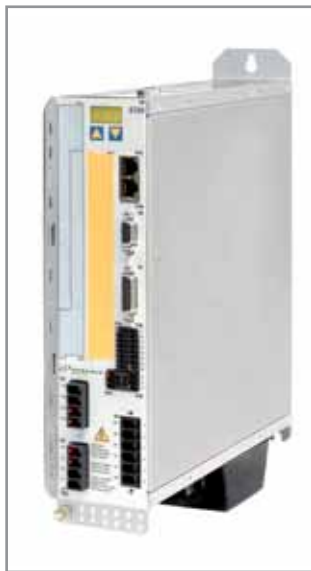
Il servozionamento c.a. S700 di Kollmorgen presenta un'interfaccia integrata per il collegamento a Ethernet
