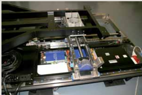
Sulle piattaforme di movimento è montata un'auto di Formula Uno, i cui reali movimenti vengono generati per mezzo di tre viti a circolazione di sfere Thomson
