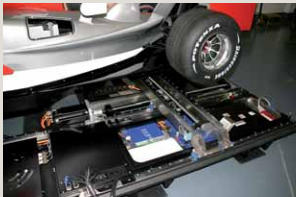
Sulle piattaforme di movimento è montata un'auto di Formula Uno, i cui reali movimenti vengono generati per mezzo di tre viti a circolazione di sfere Thomson
