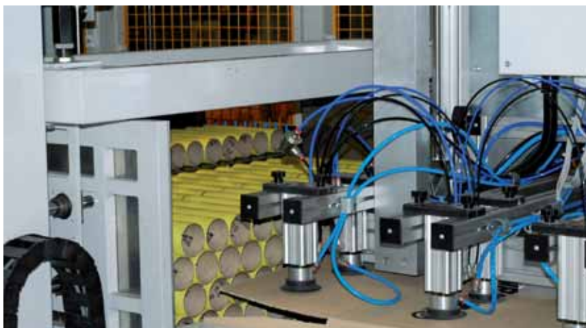
La stazione formatrice preleva il cartone, dà forma alla scatola e la colloca davanti alla pila di tubi
