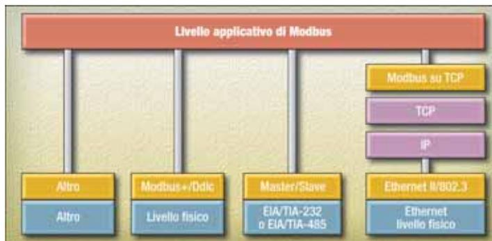
**Struttura di comunicazione del protocollo Modbus**
