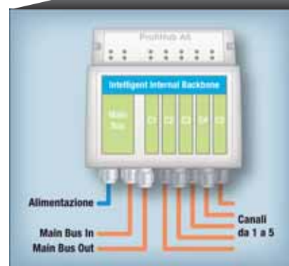
Figura 3 - Si possono creare reti a stella o ad albero inserendo dei ProfiHub
