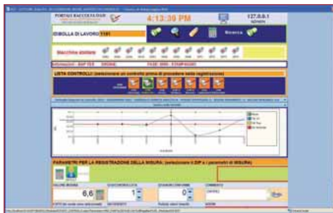
Figura 6 - Maschera registrazione misure di controllo con controllo real-time range di tolleranza
