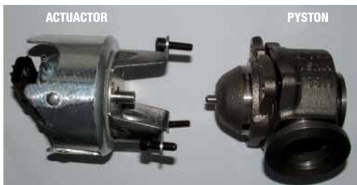
La valvola VT2 è costituita da due parti definite 'actuator' (il componente che movimentata il corpo valvola) e 'pyston' (il componente meccanico connesso al turbocompressore)
