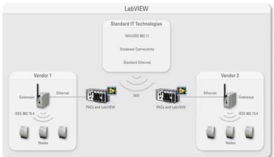
**I sistemi di misura ibridi impiegano una piattaforma software aperta per combinare diversi strumenti di misura, indipendentemente dal bus di comunicazione impiegato e dal produttore**
