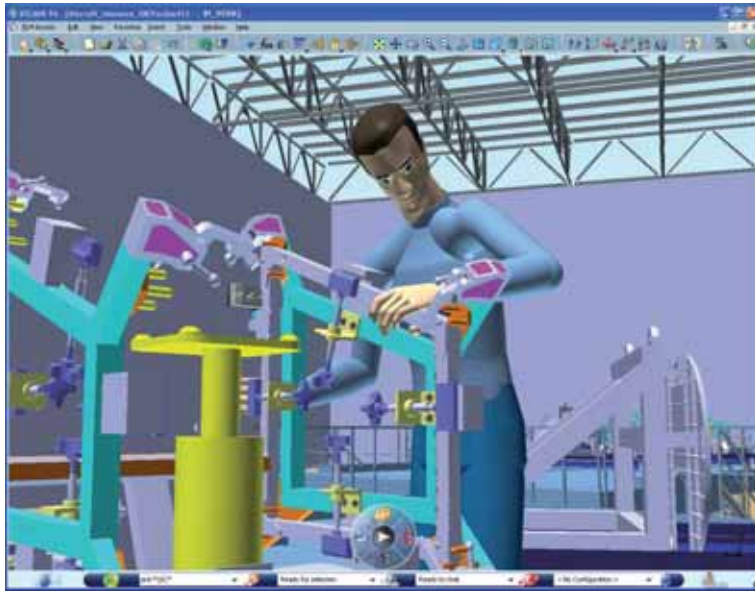
Delmia V6 permette di simulare nel dettaglio i movimenti degli addetti a una linea di montaggio
