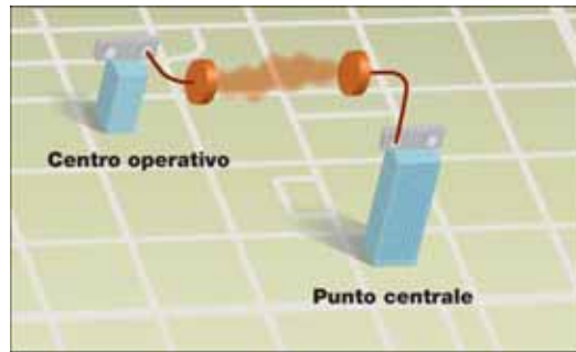
QuickBridge fornisce un collegamento fino a 108 Mbps aggregati tra il Centro Operativo e il Punto Centrale
