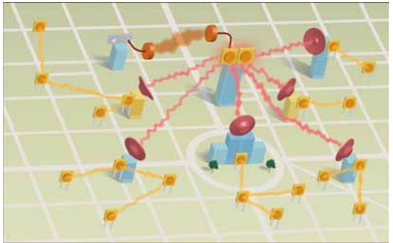
Nella rete di accesso mesh il traffico proveniente dagli 'access point' viene aggregato e poi trasportato verso il Centro Operativo tramite il sistema MP.11 e QuickBridge
