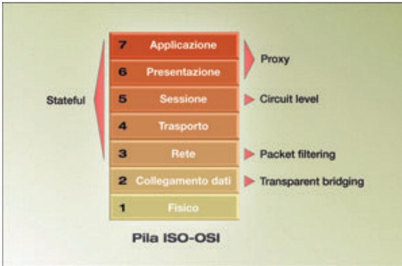
Figura 3 - Esistono diverse tipologie di firewall, ciascuna delle quali agisce a livelli differenti della pila ISO-OSI
