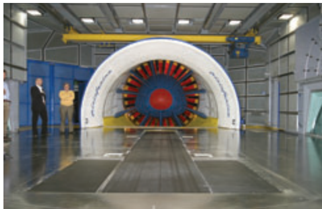
Il tappeto a T si estende fin dietro la vettura consentendo la simulazione e il calcolo del coefficiente aerodinamico
