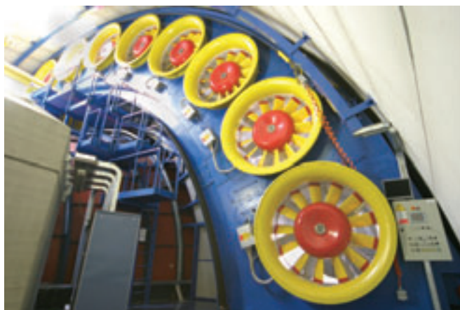
13 eliche esterne spingono l'aria nella camera a 250 km/h
